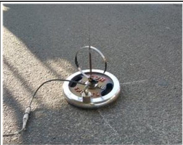
처짐계 설치 현황
